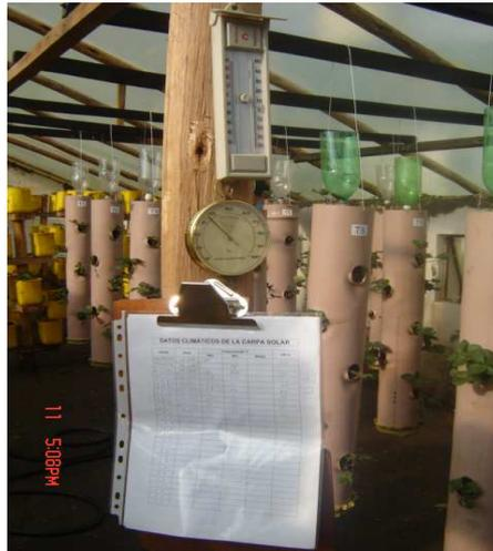
**Figura 25:** Termómetro y el higrómetro instalados en el ensayo
